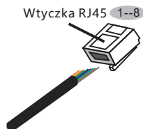
Rysunek 3.22 Zdjąć warstwę izolacyjną i podłączyć do wtyczki Rj45
