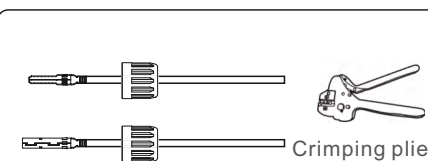
Figura 5.15 Prenda o pino de contato ao fio Alicate de crimpagem
