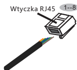
Rysunek 3.23 Usunięcie warstwy izolacji i podłączenie do wtyczki Rj45
