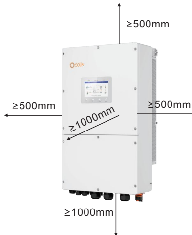
Figura 3.5 Distâncias para montagem do inversor
