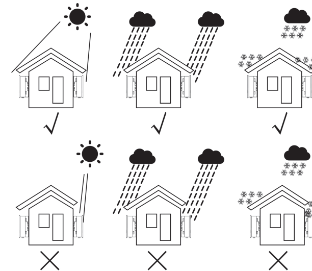
Малюнок 4.1 Рекомендовані місця встановлення
